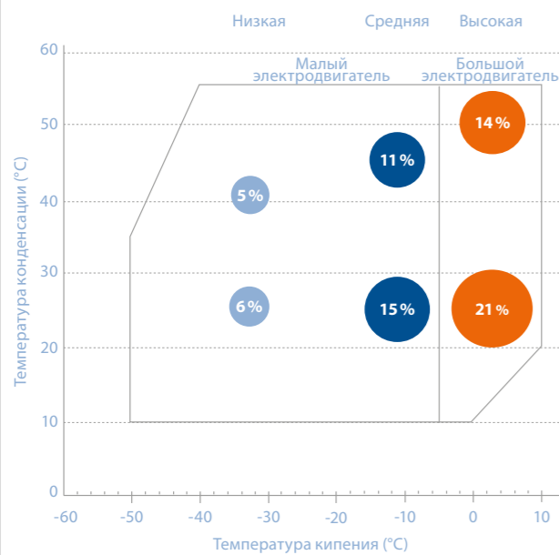
Рисунок 1: Преимущества компрессоров Stream при использовании хладагента R404A по сравнению с любой конкурентной моделью в различных точках рабочего диапазона.
